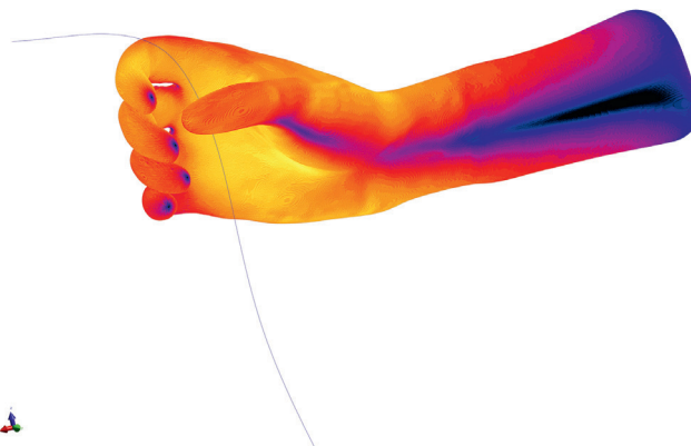
Abb. 3. Feldverteilung der induzierten elektrischen Feldstärke an der Hautoberfläche beim Bolzenschweißen mit Kondensatorentladung und Handhaltung P1; die blaue Linie zeigt den verwendeten Strompfad im Haltegriff der Schweißpistole
