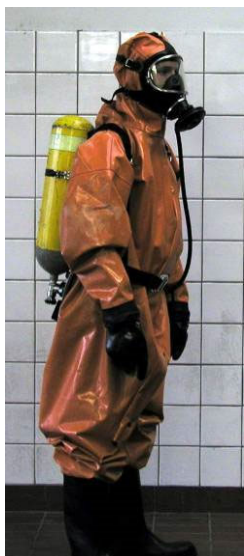
Vollschutzanzug mit schwerem Atemschutz, gasdicht
