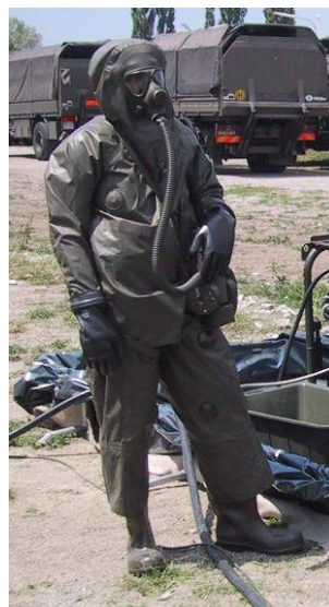
zweiteiliger -durch Überdruck gasdichter- Vollschutzanzug mit Überdruckbelüftungsgerät (leichter Atemschutz)
