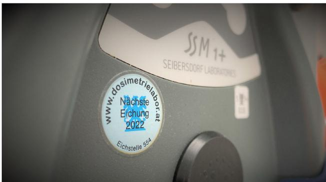
Foto eines geeichten Ortsdosisleistungs-Messgerätes. Im Vordergrund sieht man den Erinnerungsaufkleber „Nächste Eichung“. Zur besseren Unterscheidbarkeit wird die Farbe jährlich gewechselt.
