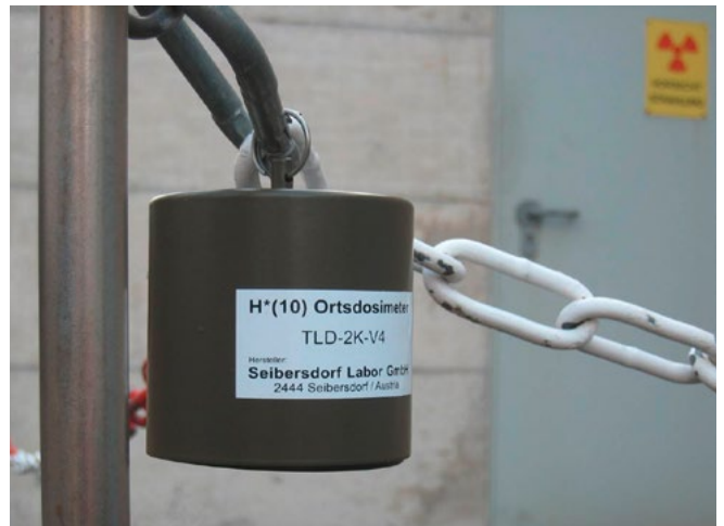
Ortsdosimeter TLD-2K-V4 im Einsatz zur Umgebungsüberwachung
