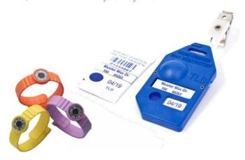
Die FINGERRING-DOSIMETER sind für die Ermittlung einer Teilkörperdosis. Der Lithiumfluorid-Kristall befindet sich auf dem Trägerplättchen eines verstellbaren Kunststoffringes. Messbereich: 0,5 mSv bis 10 Sv; Energiebereich: 12 keV bis 1,3 MeV; Messgröße: Personendosis H\_(0,07).
