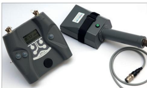
Abbildung 2: SSM1+ Handmessgerät mit Großflächensonde zum Abspüren von Fahrzeugen (Suchen und Finden von Quellen)
