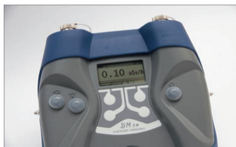
Abbildung 3: SSM1+ Handmessgerät, Nachfolgemodell des SSM1 mit USB Kommunikation, robust und wasserdicht
