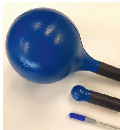
Abb. 2. Kombinierte isotrope Spulen- und Hallensoren mit 100 cm<sup>2</sup> (oben) und 3 cm<sup>2</sup> (Mitte) Spulenquerschnitt sowie isotroper Hallensensor (unten)
