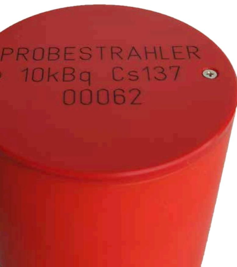
Abb. 5: Kalibrierquelle in Marinelli-Geometrie (<10 kBq Cs-137)
