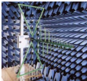
BILOG Antenne 30 MHz - 2 GHz
