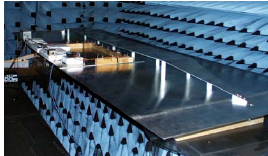
Prüfung eines Kabelbaums in der Streifenleitung
