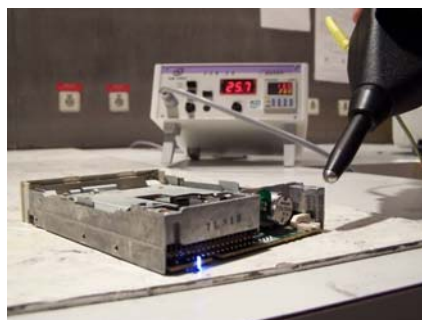
Laborprüfung eines Tischgerätes nach EN 61000-4-2
