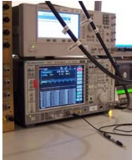
Spektrum 30 MHz – 1 GHz, frequenzselektiv, Peakmessung
