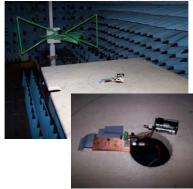
Absorberhalle Max Hold 30 – 1000 MHz alle 4 Richtungen (1 m Messabstand da sonst Pegel zu gering, keine Ground Plane, nicht normgerecht)
